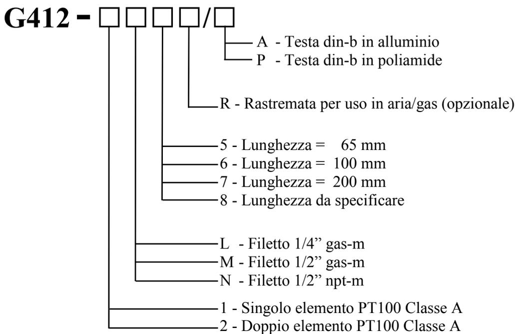
Questo modello di sonda è indicata per rilevamenti ad immersione. Ha un grado di protezione IP65. Lo stelo è in AISI316L (ASTM-A479-Ultima Edizione) ed ha una buona resistenza alle vibrazioni.
